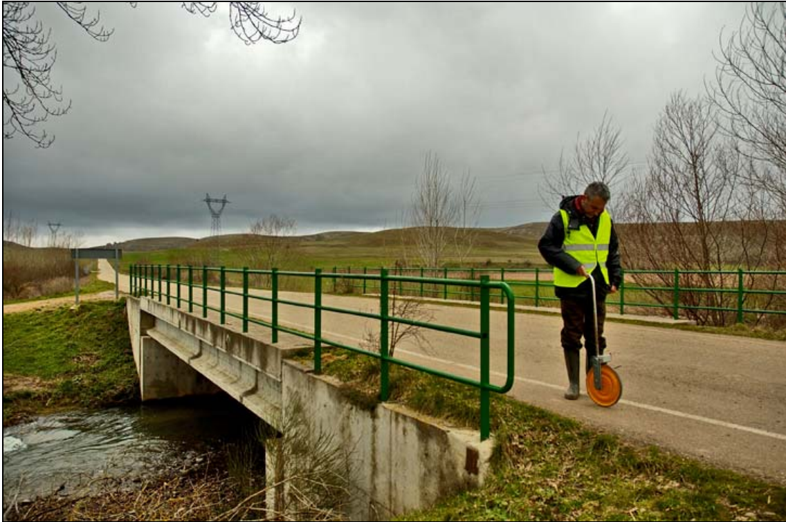
- FOTO 6 Barandilla. Medición de su longitud.
